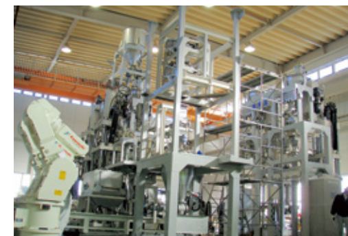
次世代自動車向けにニーズが高まる(2次電池陽極材の計量粉砕設備)
